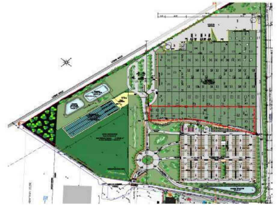
Diminution de la zone de stationnement passant de 1029 places à 819 places , pour une surface d'emprise au sol de 15727 m<sup>2</sup> (ne tient pas compte du niveau du parking R-1 qui reste inchangé). Les parties entourées d'un tiret rouge sont les zones impactées par la diminution des places de stationnement.
